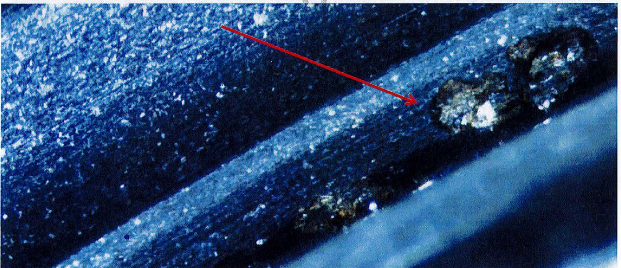
Bild 3, 4 und 5 – Fremdpartikel in der Weichdichtung (PTFE/Kohle)
